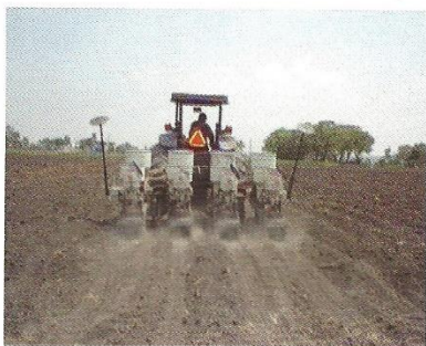
Sembradora para maíz utilizada para la siembra de Amaranto en el Estado de México
