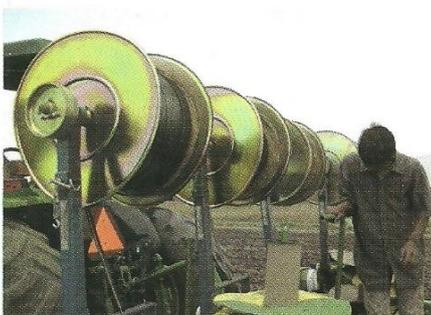
Montaje al tractor de la cinta de riego por goteo para su instalación
