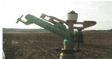
Instalación del cañón con entrada a 2 pulgadas y salida de boquilla de 1 pulgada
